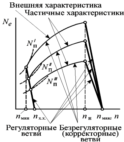
Рисунок 76 - Внешняя и частичные скоростные характеристики дизеля, снабжённого двухрежимным регулятором
