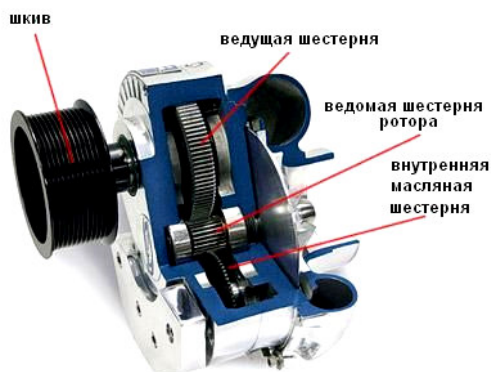
Рисунок 166 - Устройство центробежного нагнетателя
